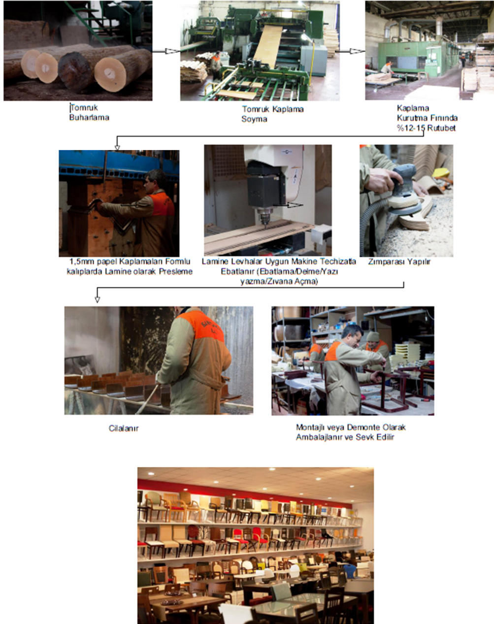
Şekil 3.2. Genel hatlarıyla lamine sandalye üretim tesisi (Sancaklı Mobilya Örneği)
