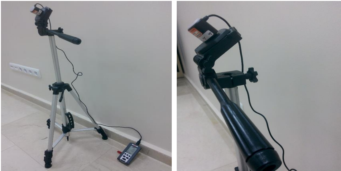
Şekil 3.10. Işınım ölçü cihazı ve tripot
