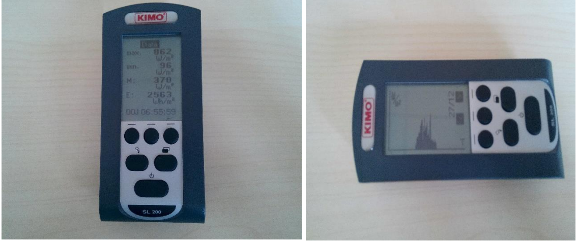
Şekil 3.9. Işınım ölçüm cihazı
