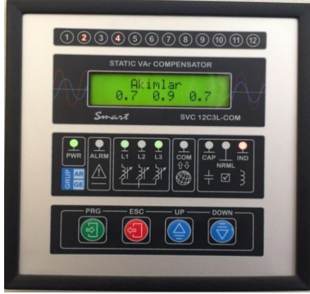
Şekil 3.4. L2 fazının kompanzasyon anındaki akım değeri.
