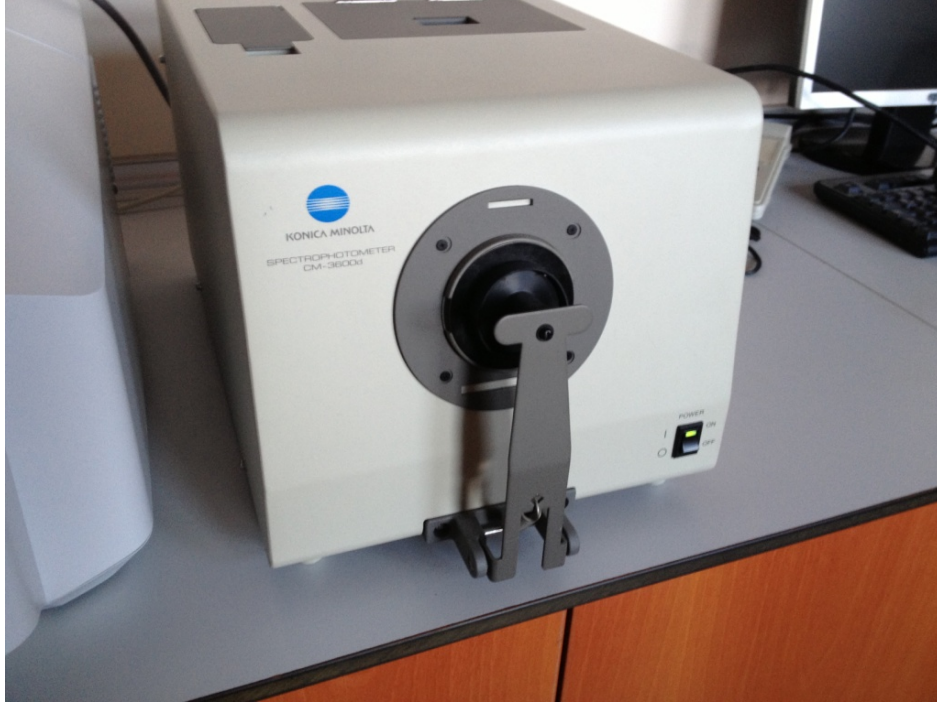
Şekil 2.11. KONICA MINOLTA Spectrophotometer CM-3600d cihazı ile renk değerlerinin belirlenmesi (Çolak 2014).
