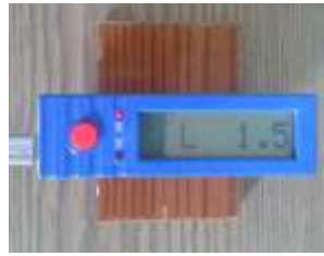
Őekil 2.8. Boya / vernik katmanı yüzey parlaklık ölçüm cihazı (Foto Ayata).
