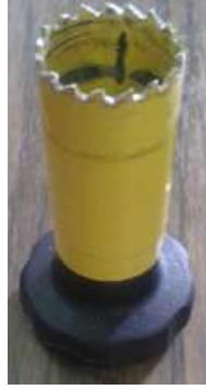
Şekil 2.15. Tutkalın kurumasından sonra çekme silindirinin çevresinde oluşan tutkalın alınması için kullanılan kesici deney aleti (Foto Ayata).
