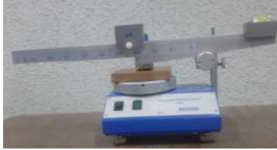
Şekil 2.12. Çizilme direnci deney aleti (Foto Ayata).
