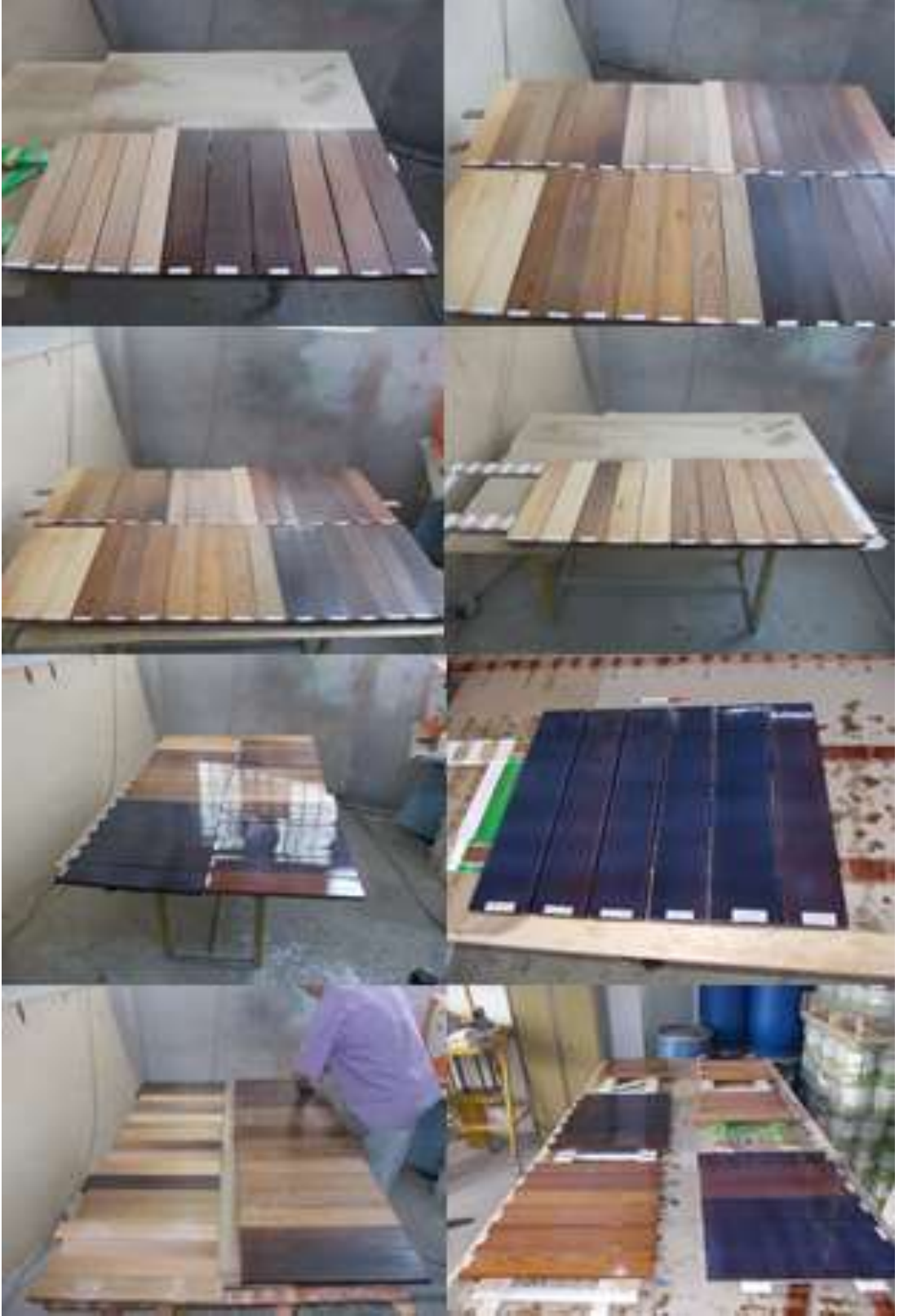
Şekil 2.2. Su-bazlı tek ve çift bileşenli verniklerin uygulaması (Foto Ayata).
