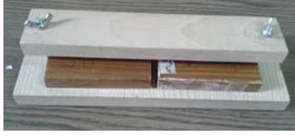
Şekil 2.14. Çekme silindirlerinin ahşap bir düzenek yardımıyla vernikli yüzeye yapıştırılması (Foto Ayata).
