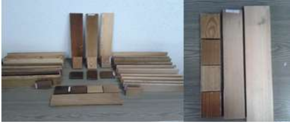
Şekil 2.3. Hızlandırılmış UV yaşlandırma uygulaması için hazırlanan deney örnekleri (Foto Ayata).
