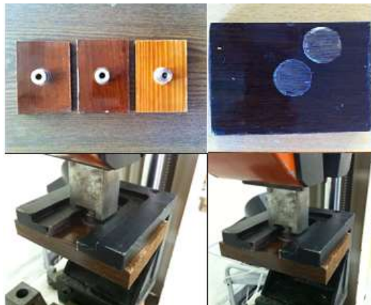
Şekil 2.13. Universal test cihazı ve yüzeye yapışma direnci aparatı (Foto Ayata).
