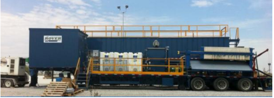
Şekil 2.17. Günde 10 000 varillik ön arıtma kapasiteli mobil arıtma tesisi [33]
