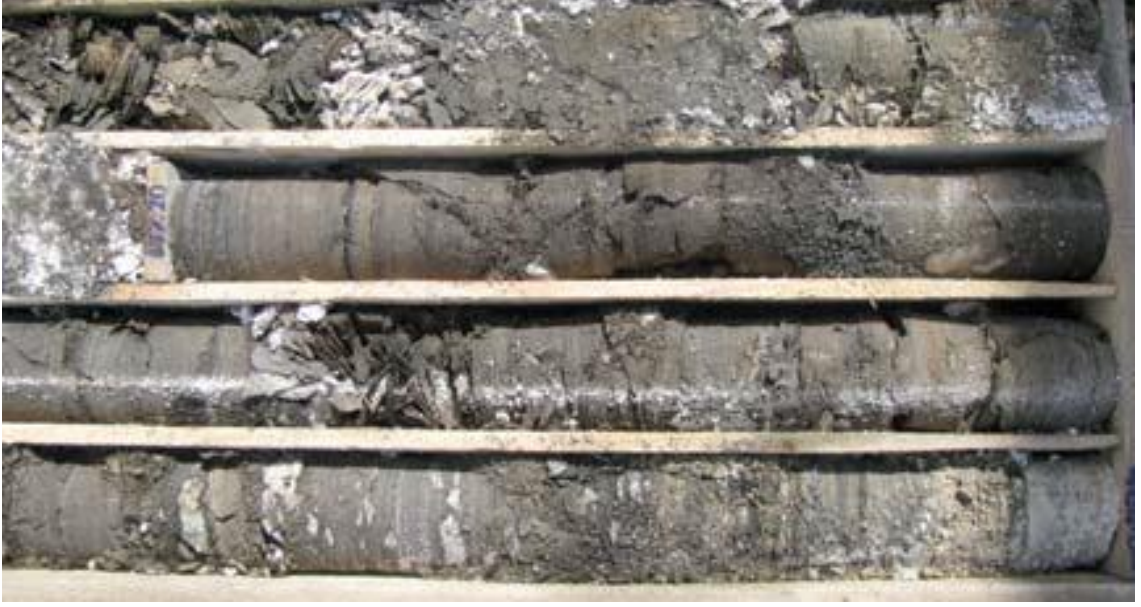
Şekil 3.1. Konya-Ereğli-Yeniköy sondajında kesilen petrollü şeyl ve sodyum sülfat tuzu [20]
