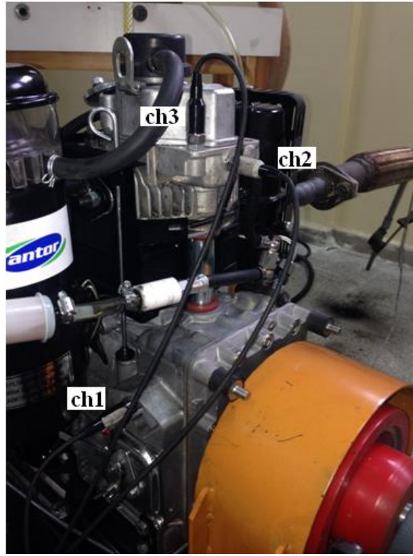
Şekil 3.12. İvme ölçerlerin motor üstündeki konumları.
