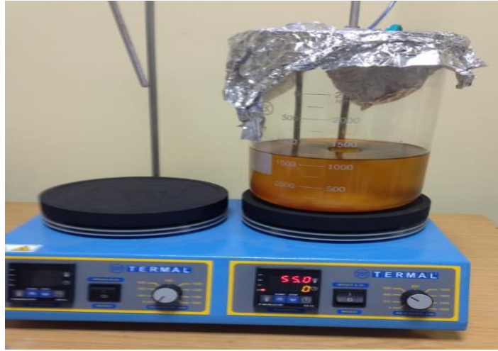
Şekil 3.2. Biyodizel üretimi (Esterleştirme reaksiyonu).
