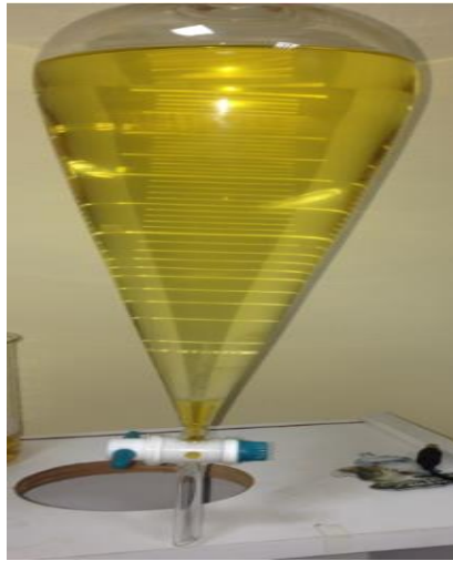
Şekil 3.4. Gliserinden ayrılmış biyodizel.
