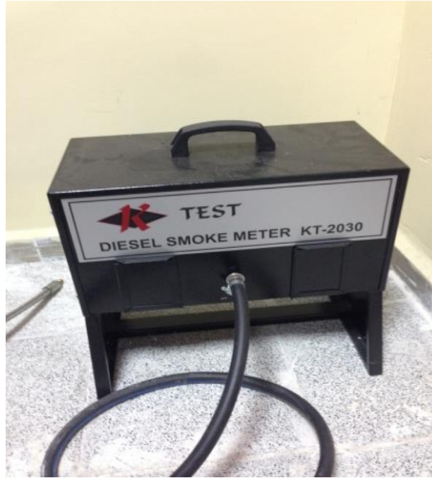
Şekil 3.10. K Test duman ölçer.
