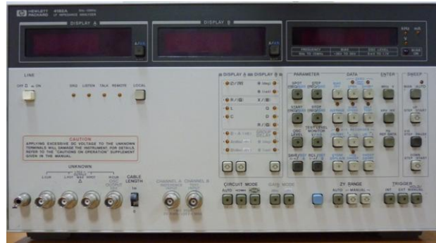
Şekil 2.5. C-V ve G/\omega-V ölçümleri için kullanılan HP4192A LF empedans analizörü.
