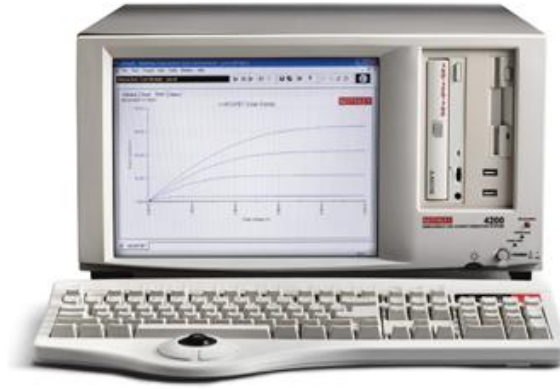
Şekil 2.4. I-V ölçümleri için kullanılan Keithley 4200 SCS akım-voltaj kaynağı.
