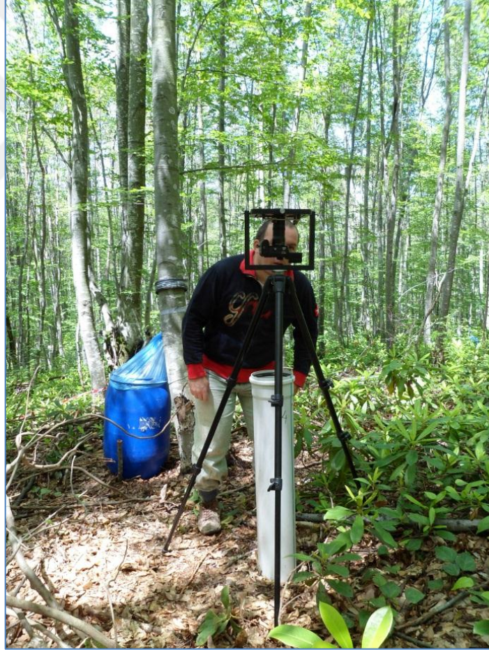
Şekil 2.5. Balıkgözü lens monteli fotoğraf makinesi ile görüntü alınması.
