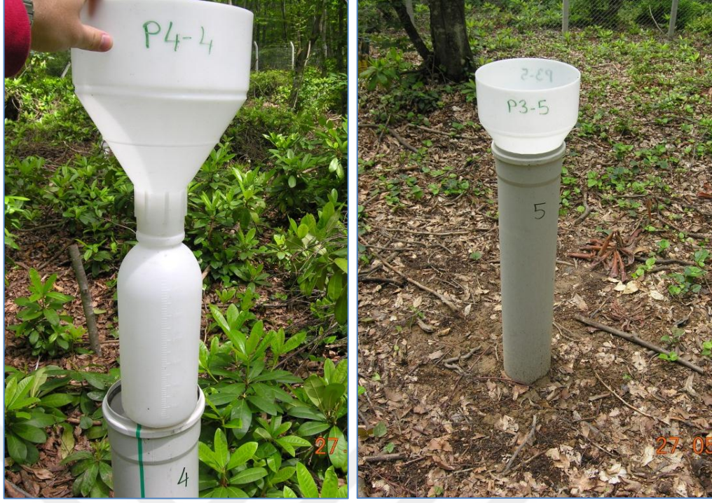
Şekil 2.8. Orman altı yağış ölçme ve toplama kapları.
