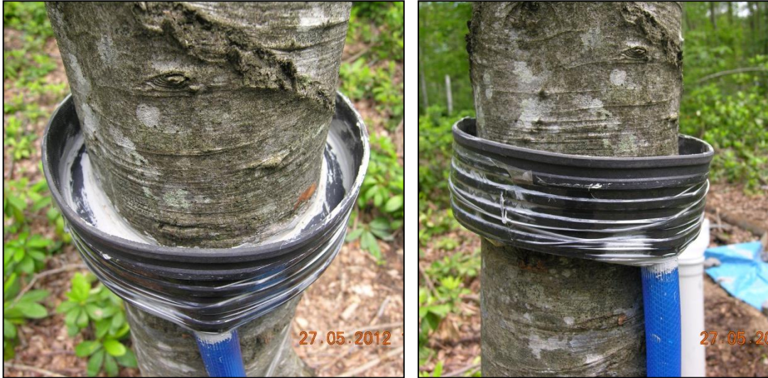
Şekil 2.9. Gövdeden akış ölçme düzenekleri.
