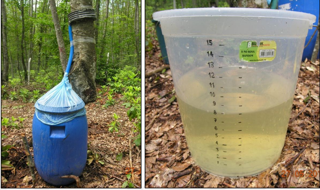
Şekil 2.10. Gövdeden akış su toplama varilleri ve ölçekli ölçüm kovası.
