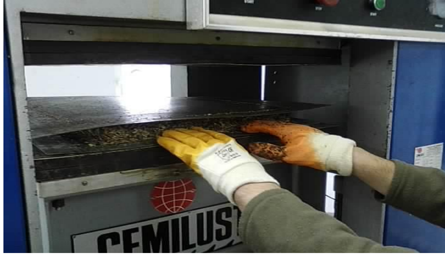
Şekil 2.5. Yonga levha taslağının hidrolik sıcak preste preslenmesi
