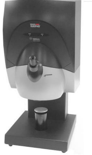
Şekil 3.8: Elrepho 2000 opaklık, parlaklık, beyazlık test cihazı
