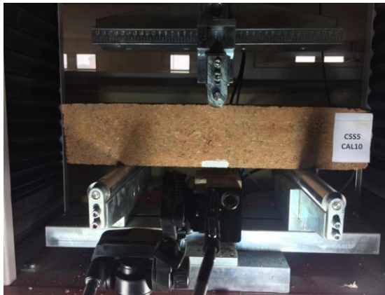
Şekil 2.20. Eğilme dayanımı deneyi
