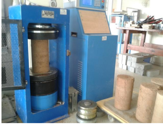
Şekil 2.19. Silindir numuneler üzerinde basınç dayanımı deneyi
