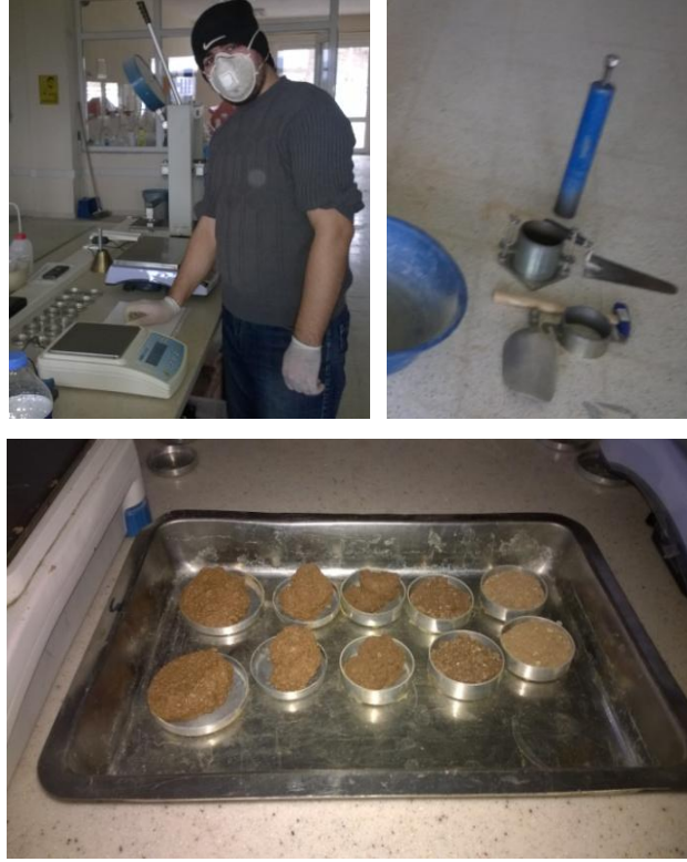
Şekil 2.18. Sıkıştırma (Proktor) deneyinden görüntüler
