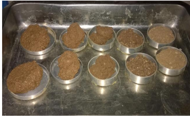
Şekil 3.2. Sıkıştırma (Proktor) deney işlemleri
