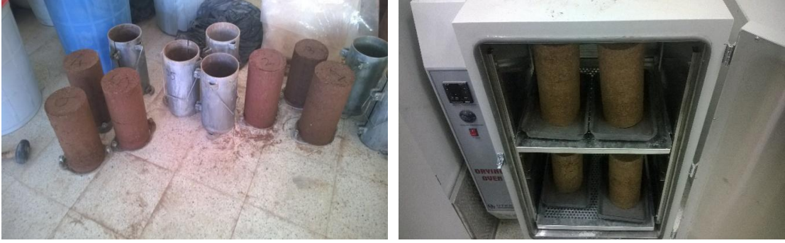
Şekil 2.17. Yaş ve kuru haldeki numune örnekleri
