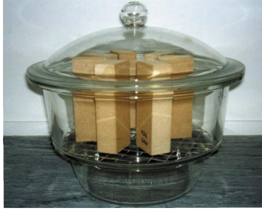
Şekil 1.7. Desikatör Test Aparatı (JIS A 1460, 2001).
