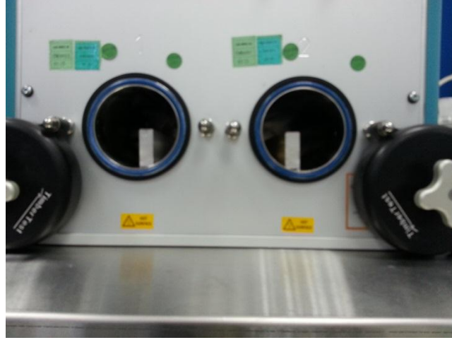
Şekil 2.11. Gaz analiz numunesinin cihaza yerleştirilmesi
