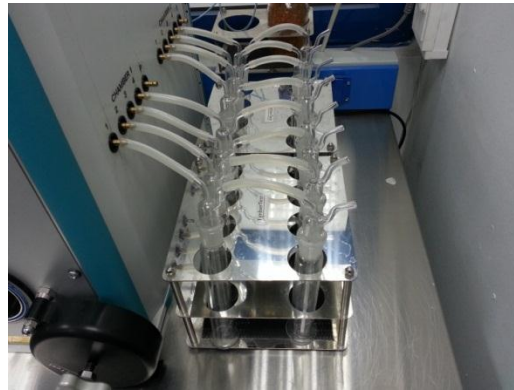
Şekil 2.12. Gaz analiz cihazına yıkama şişelerinin yerleştirilmesi.
