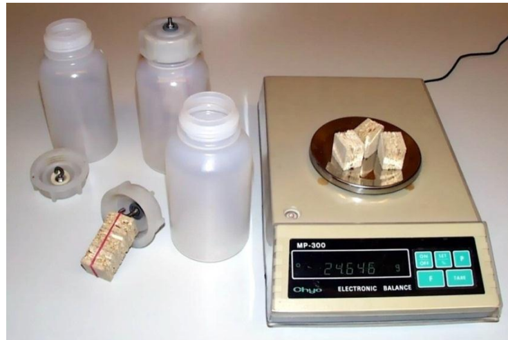
Şekil 1.6. Şişe Metodu Test Aparatları (TS EN 717-3, 1999)
