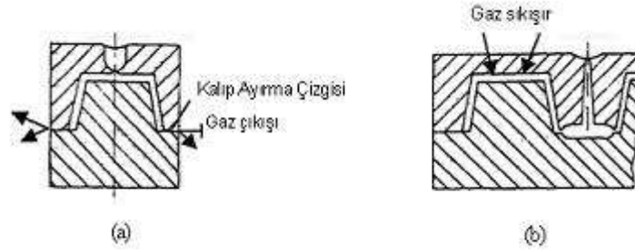
Şekil 2.10. a) Tek Gözlü Kalıpta Gaz Tahliyesi b) Çok Gözlü Kalıpta Gaz Tahliyesi
