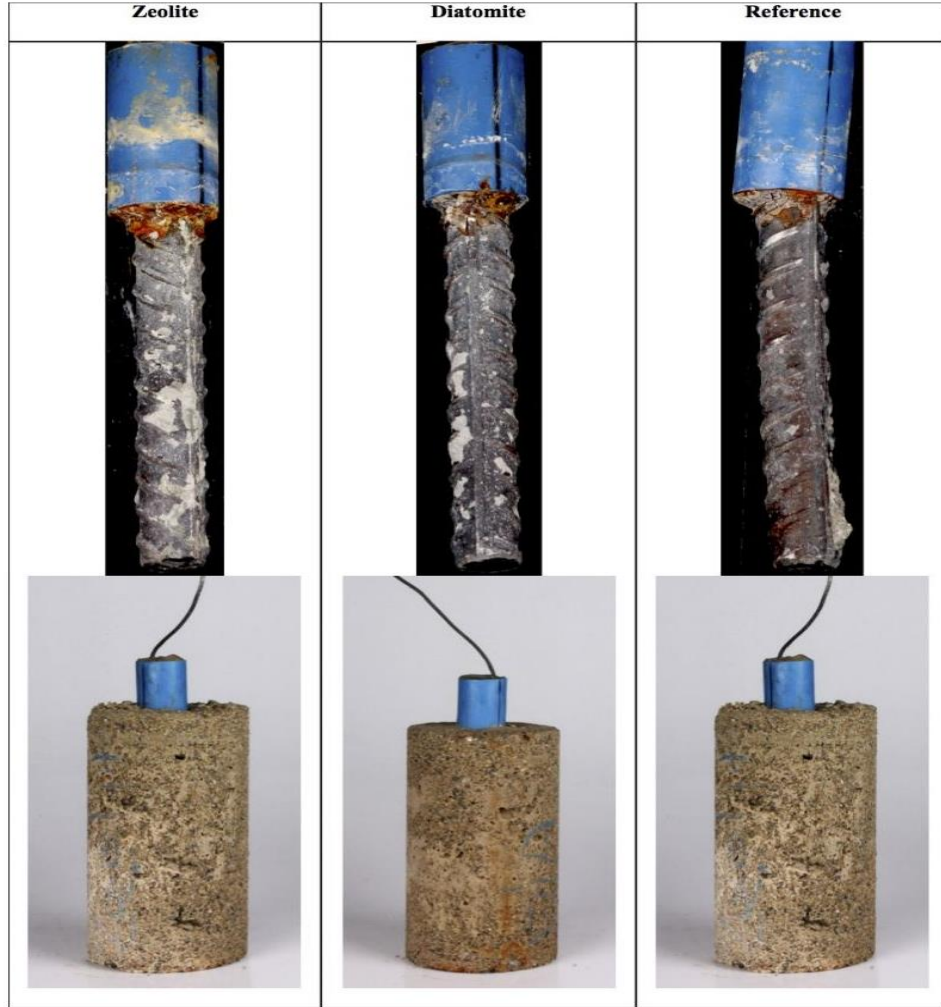
Şekil 3.6. 1 M HCl çözeltisine batırılan beton içinde gömülü donatı çeliğinin 240 gün sonraki görüntüleri.
