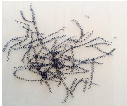
Şekil 5.9. FG formunun 200 m/dak. kesme hızında 0,25 mm talaş derinliğinde ve 0,1 mm/devir ilerleme hızındaki talaş formu
