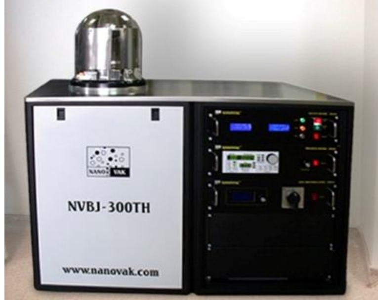
Şekil 3.2. Omik ve doğrultucu kontak oluşturulurken kullanılan metal buharlaştırma cihazı
