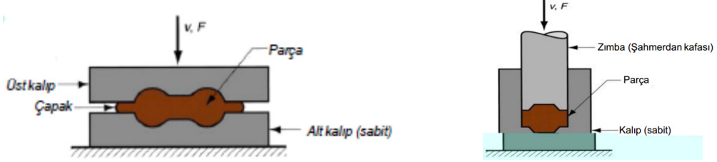
(a) Kapalı kalıpta çapaklı dövme. (b) Kapalı kalıpta çapaklız dövme.
