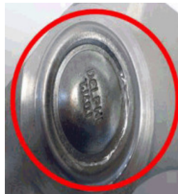
Şekil 3.18. İki makaralı sıvama aparatı ile sıvanmış rotbaşındaki bir sıvama hatası.
