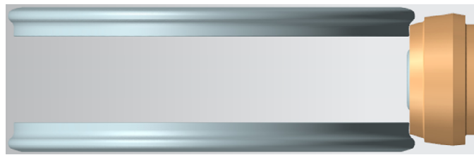
(d) Rotbaşının ikili makara ile birlikte montaj katı modeli.
