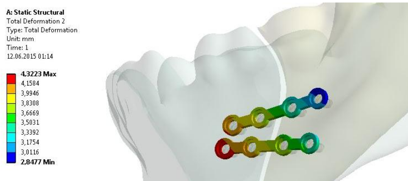
Şekil 3.50. I-A plak ile fiksasyonda oluşan deformasyon
