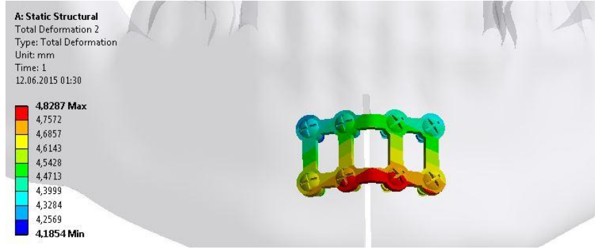
Şekil 3.39. Dikdörtgen-A tip plaklı fiksasyonda oluşan deformasyon
