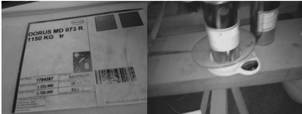
Şekil 1.6. Dorus PVAc D3 & D4 özellikli tutkal ve Dorus R.397 sertleştiricisi (Mıdıroğlu 2014).
