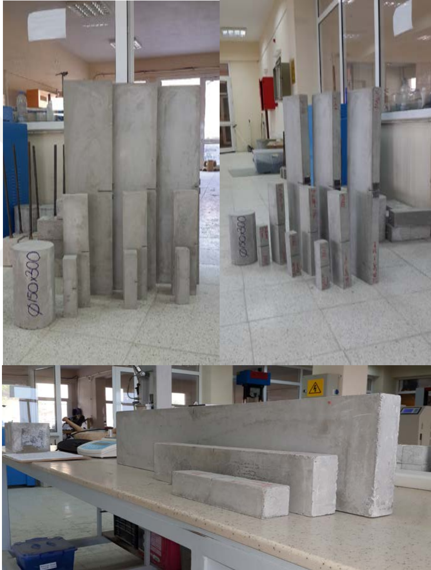
Şekil 2.10. Kırılma deneyleri için üretilen test kirişleri
