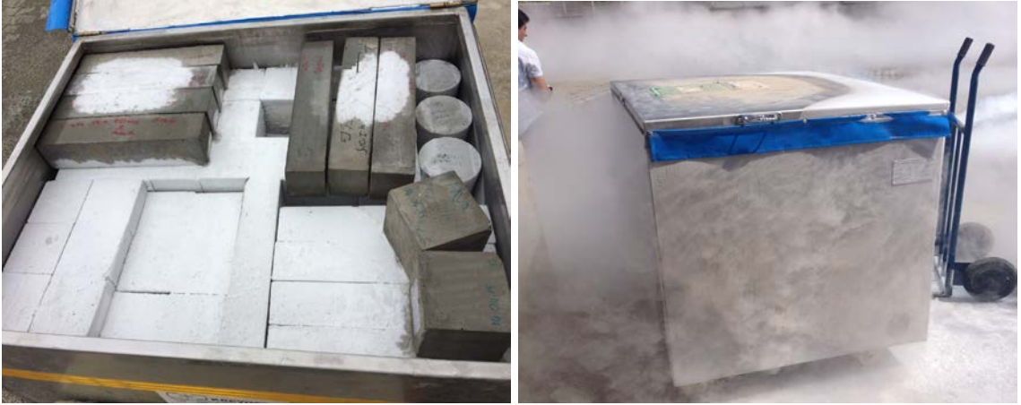
Şekil 2.5. Kriyojenik işlem sonrası numunelerin görünümü
