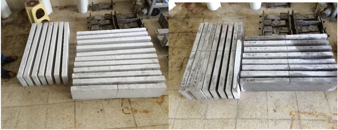
Şekil 2.6. Kriyojenik işlem sonrası büyük boy çentikli kirişler
