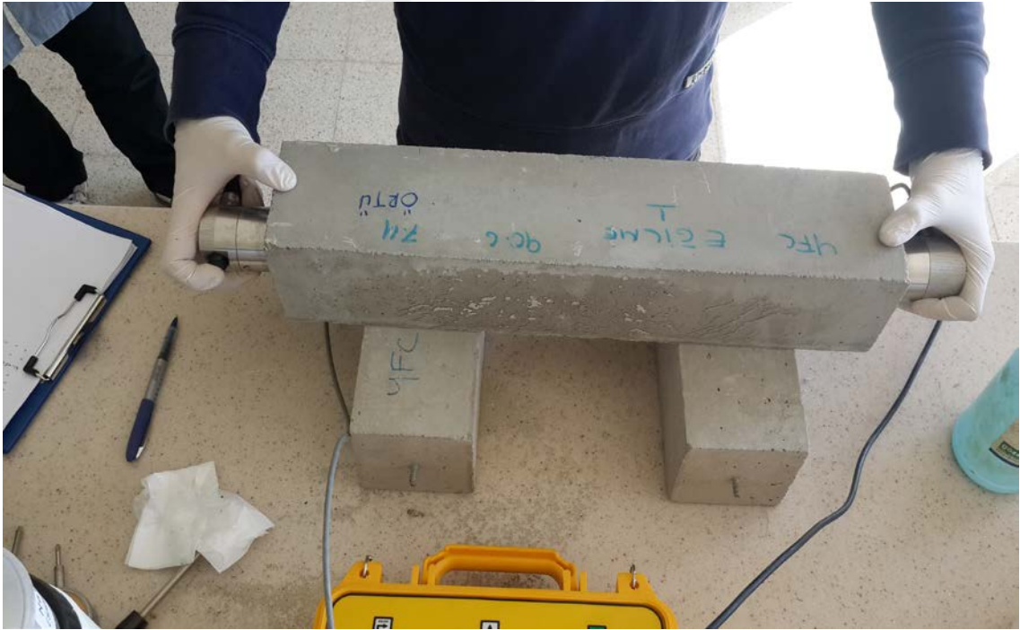
Şekil 2.8. Ultrases geçiş hızı ölçümü
