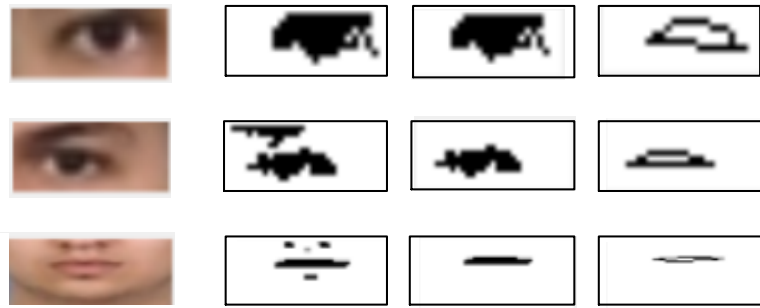
Şekil 3.5. Göz ve ağız görüntülerinden kübik Bezier eğrilerinin çıkarılması.
