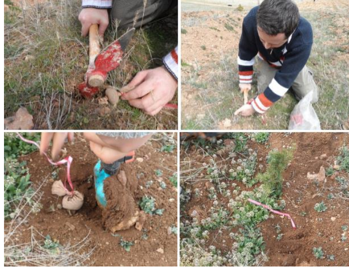
Şekil 2.16. Anyon ve katyon karışık reçine torbalarının araziye yerleştirilmesi
