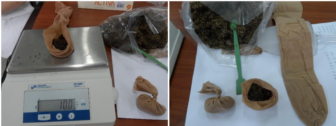
Şekil 2.15. Anyon ve katyon karışık reçine torbalarının hazırlanışı.
