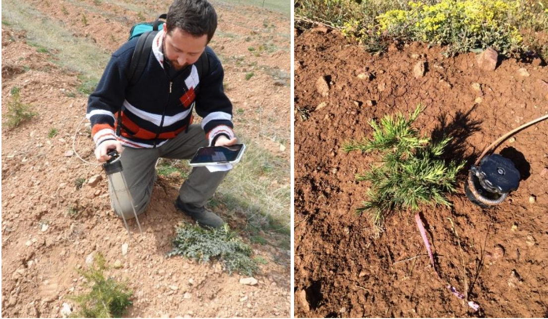
Şekil 2.14. TDR (Time Domain Reflectometry) aleti ile toprak nemi ölçümü.
