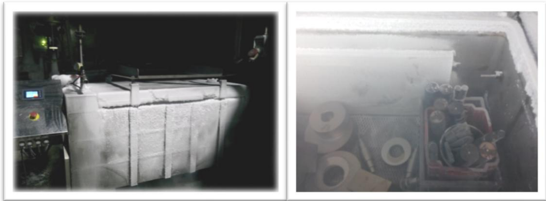
Şekil 6.4. Kriyojenik işlem fırını ve işlemin uygulanması.
