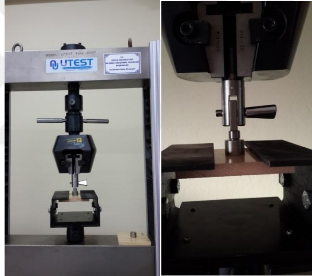
Şekil 2.12 Yapışma direnci testinin yapılışı.
