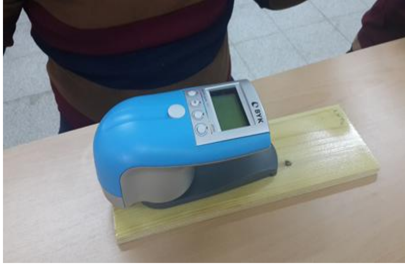
Şekil 2.9. BYK – GARDNER SPEKTRO-GUİDE 45/0 renk ve parlaklık cihazı ile ölçüm alınması.
