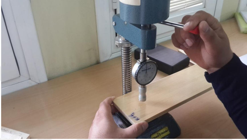
Şekil 2.8 Sertlik testinin yapılışı.
