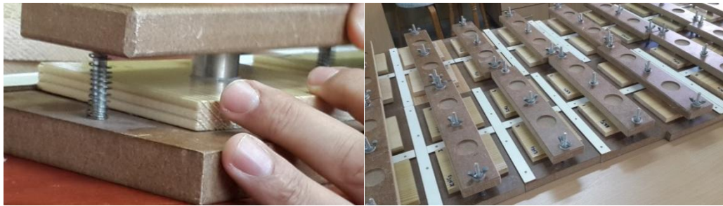
Şekil 2.10. Çekme silindirinin örnek yüzeylerine kalıp yardımı ile yapıştırılması.
