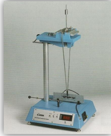
Şekil 1.2. Pandüllü sertlik ölçme cihazı (BYK Gardner).
