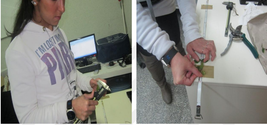
Şekil 3.13. Kök boğaz çapı (solda) ve gövde boyu (sağda) ölçümü.
