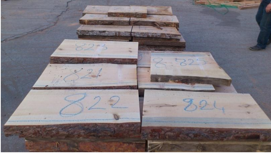
Şekil 3.3. Örnek numaralandırma (822: 8 nolu ağaç, 2. kereste, 2. Parçası (60 cm lik parçalar), mavi çizgi: örnek kesimlerine aynı taraftan başlanması için çizilmiştir)
