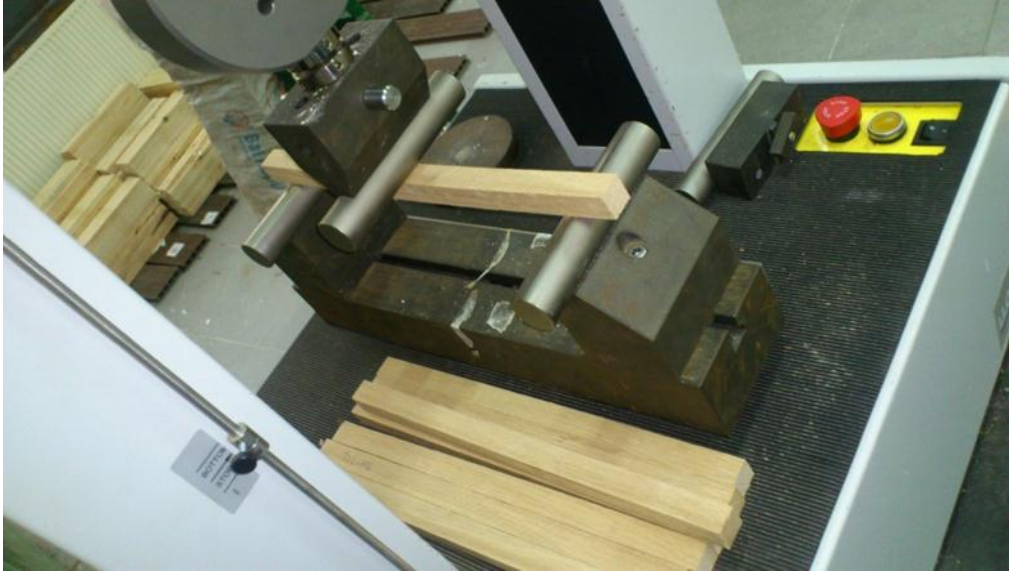
Şekil 3.7. Standart boyutlu örneklerde eğilme direnci ve eğilmede elastikiyet modülü deneylerinin yapılması
