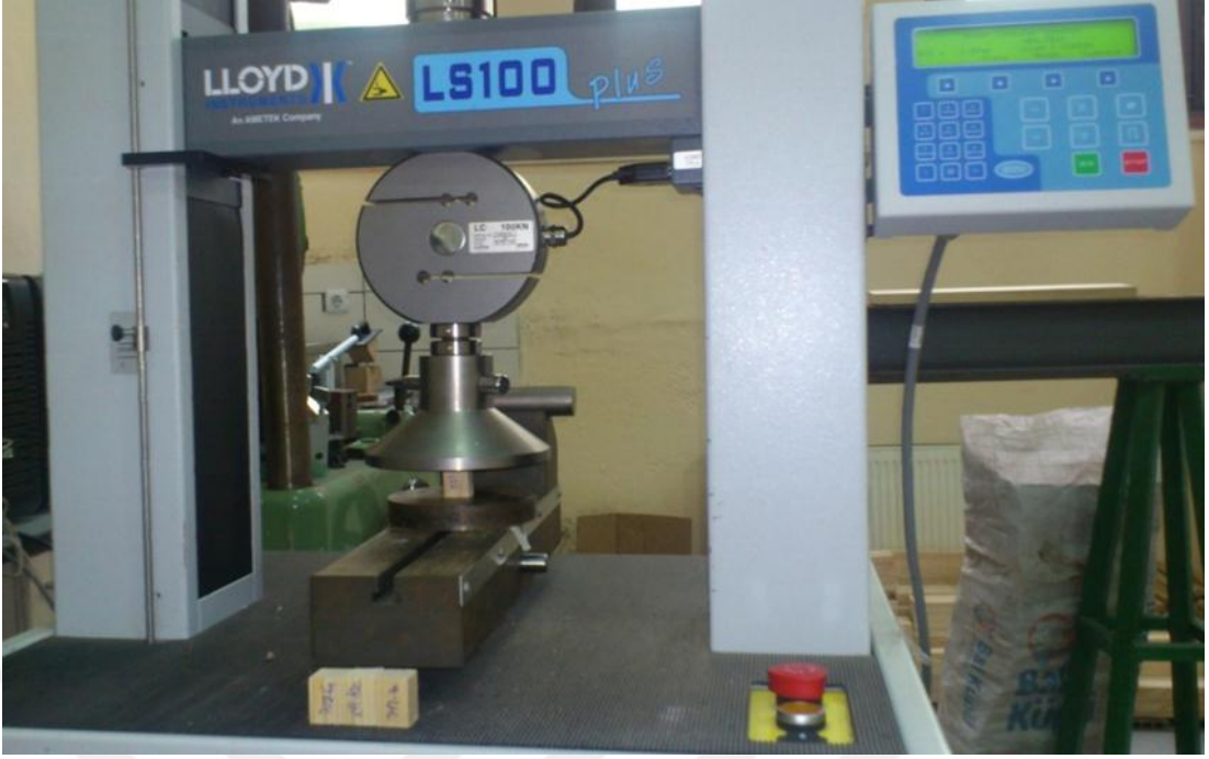
Şekil 3.8. Standart boyutlu örneklerde basınç direnci deneylerinin yapılması
