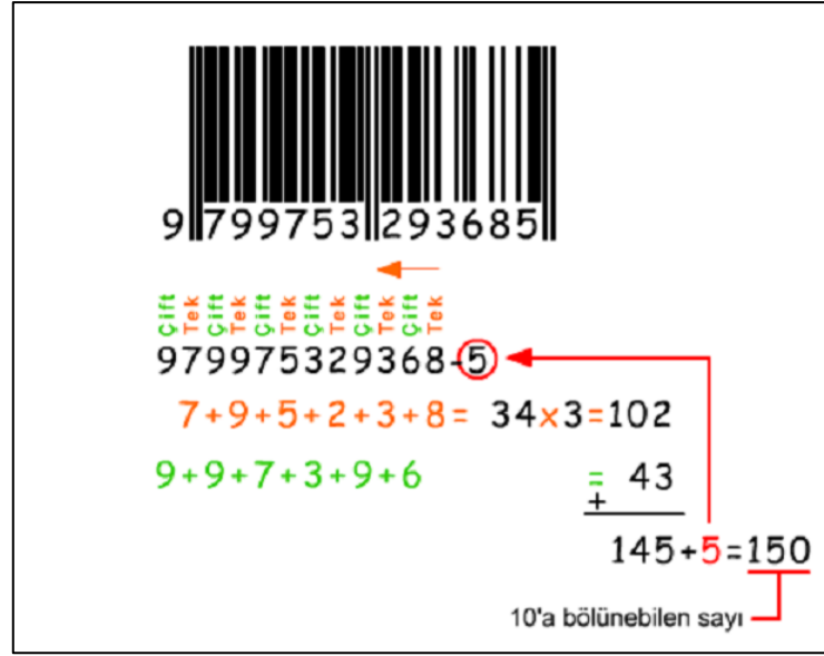
Şekil 4.5. Barkod doğruluğunun kontrolü [12].
