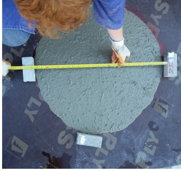
Şekil 3.8. Lastik agrega ikameli KYB yayılımı.
