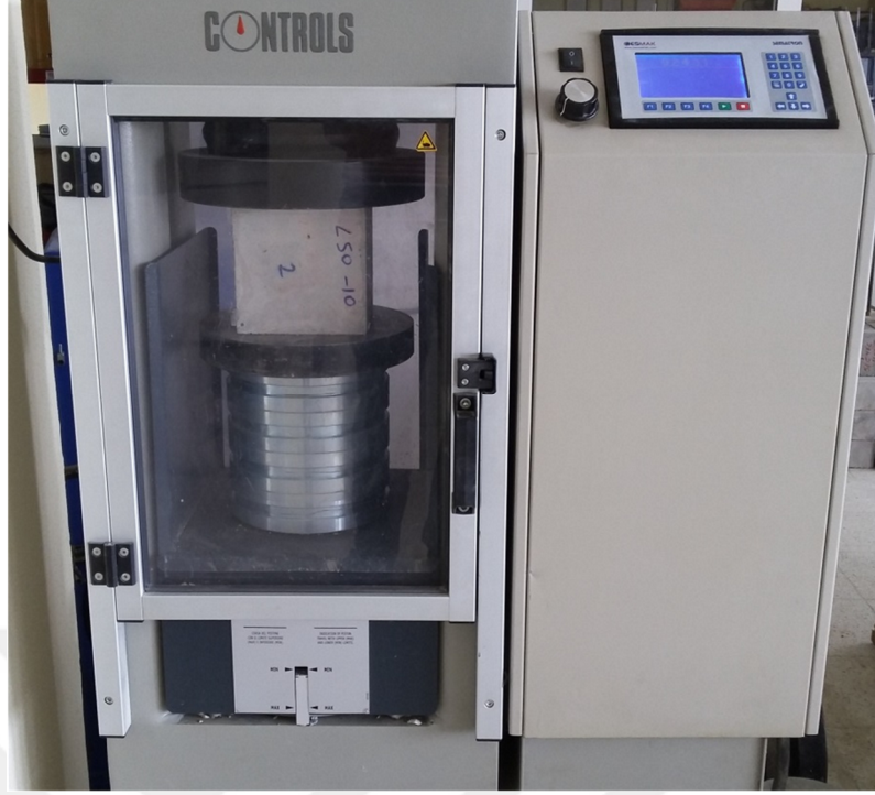
Şekil 3.11. Beton basınç dayanımında kullanılan pres.
