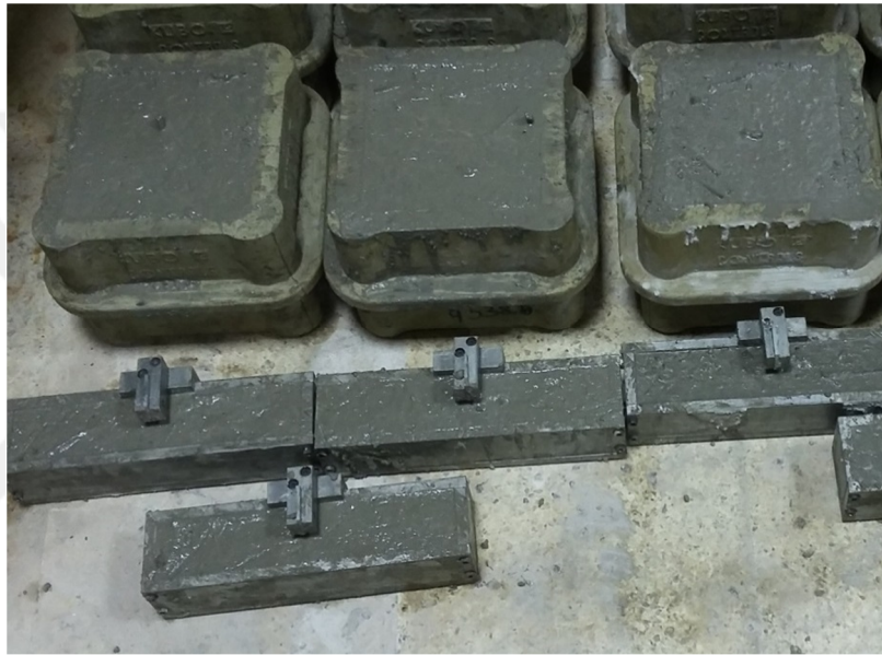
Şekil 3.7. Beton karışımının kalıplara yerleştirilmesi.
