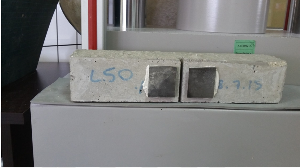
Şekil 3.12. Kırılma enerjisi deney düzeneği için numunenin hazırlanması.
