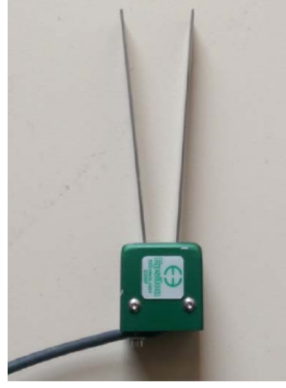
Şekil 3.14. Çatlak açıklığı ölçüm aparatı (clip gage).
