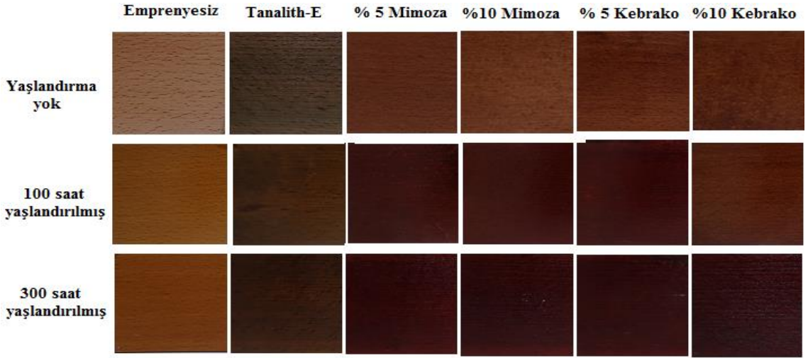
Şekil 2.4. Selülozik vernik uygulanmış deney örnekleri.
