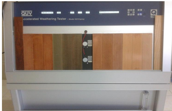
Şekil 2.2. Yaşlandırma cihazına örneklerin yerleştirilmesi.
