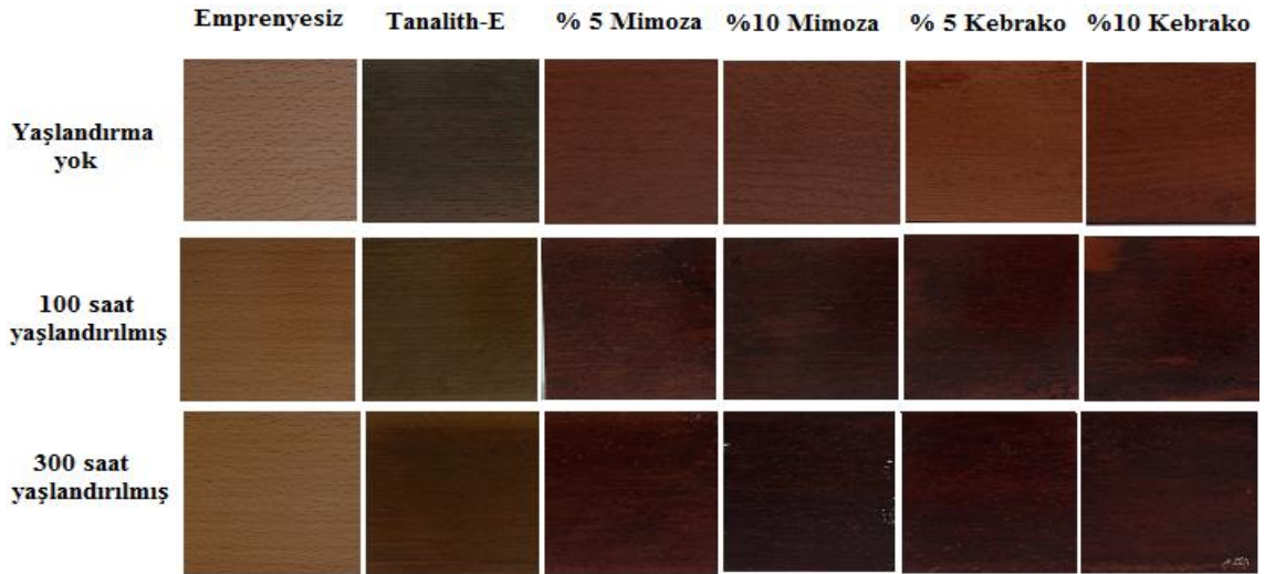
Şekil 2.5. Su bazlı vernik uygulanmış deney örnekleri.
