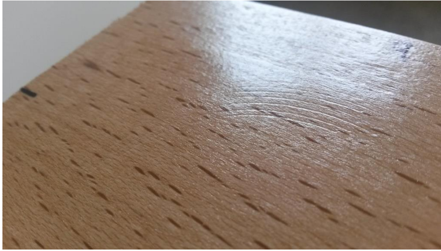
Şekil 2.10. Çizilme direnci ölçümü sonrası numunenin görünümü.
