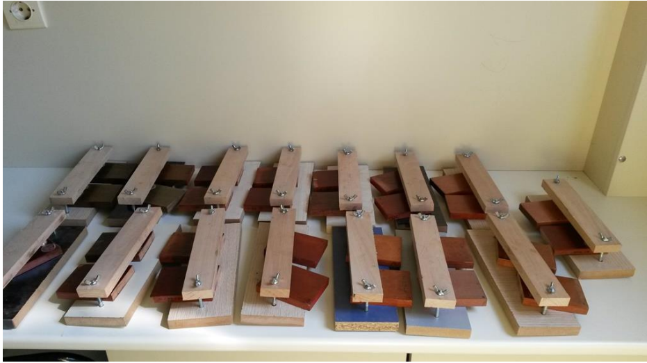
Şekil 2.7. Çekme aparatlarının sıkıştırma aleti ile sıkıştırılması.
