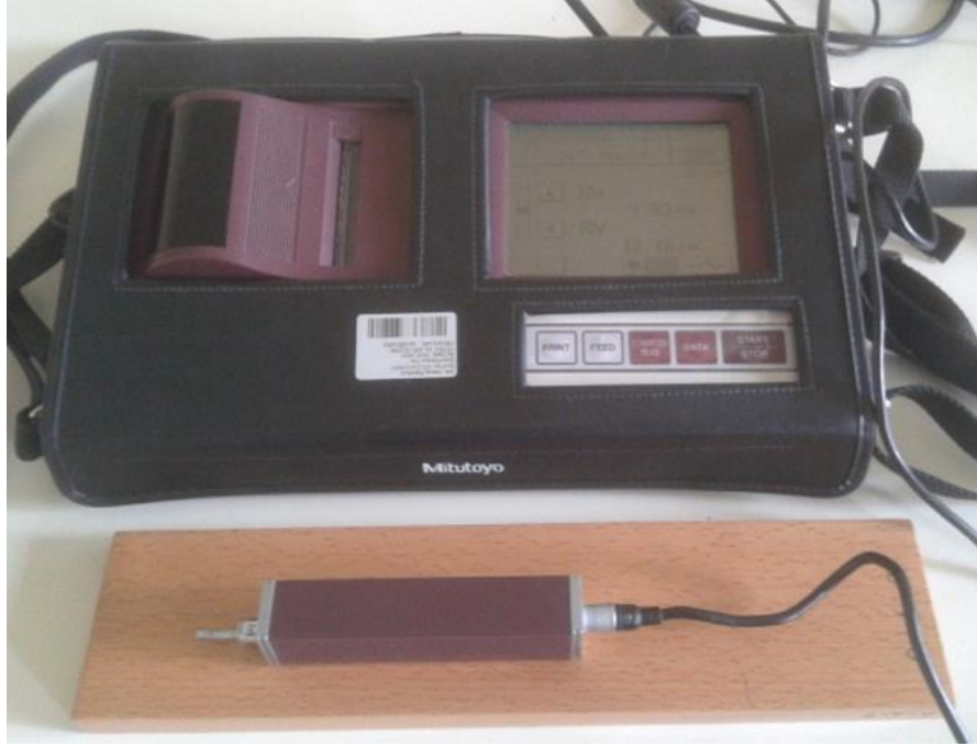
Şekil 2.8. Yüzey pürüzlülüğü ölçüm cihazı.
