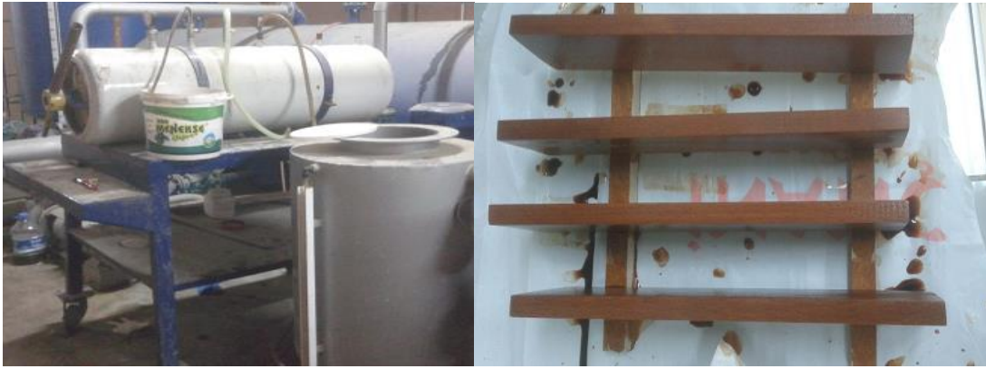
Şekil 2.1. Emprenye işleminin yapıldığı düzenek ve emprenye sonrası numunelerin yaş hali.
