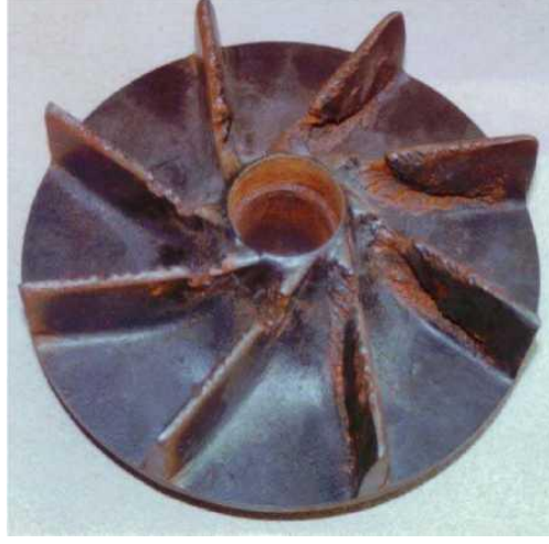
Şekil 2.12. Kavitasyona uğramış çark resmi.
