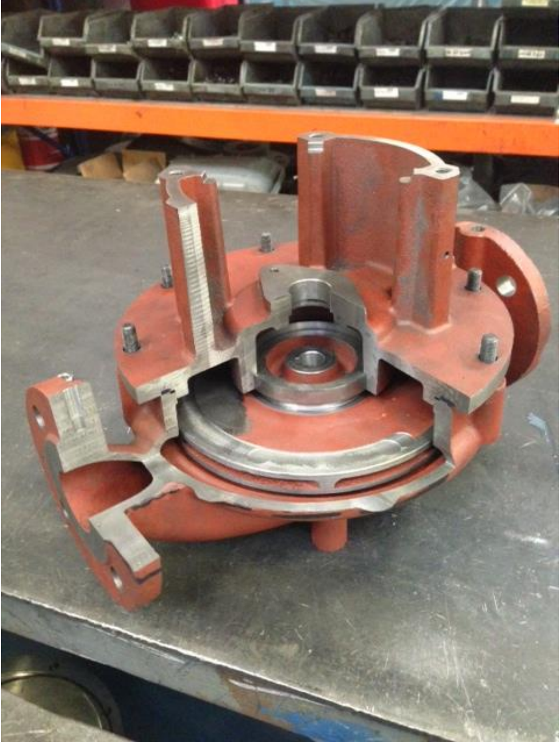
Ek-3. Inline tip santrifüj pompa gövdesi kesit resmi.
