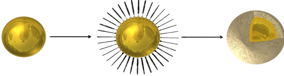
Şekil 3.2. Altın çekirdeğinin ligand ile kaplanması
