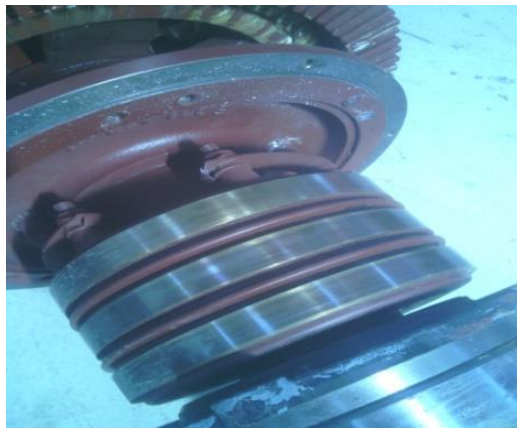
Şekil 2.5. Bilezikli Asenkron Motor Rotorundaki Bilezikler [25].
