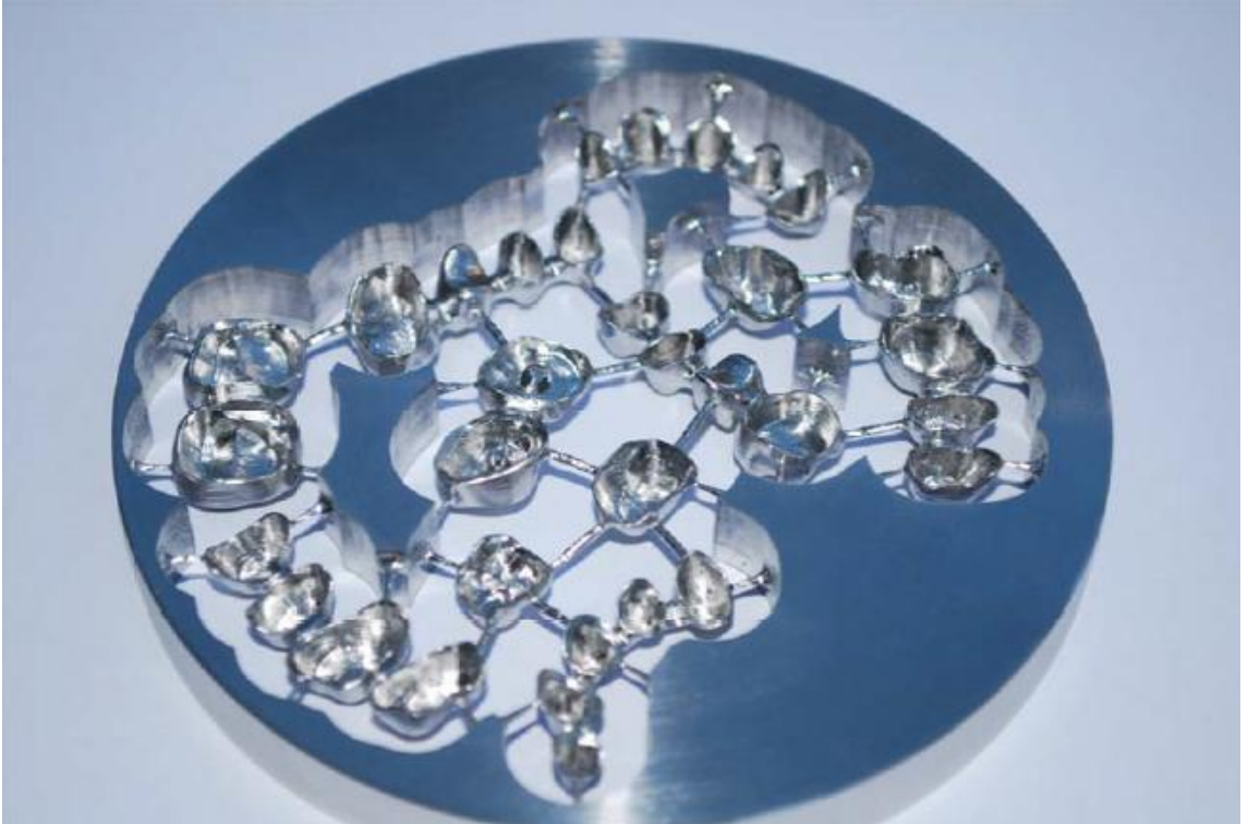
Şekil 2.13. CAD/CAM ile frezelenerek elde edilen metal alt yapılar [81].
