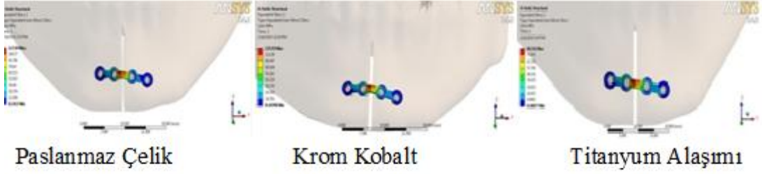
Şekil 3.7. Tek I plak üzerinde oluşan gerilmeler [129].
