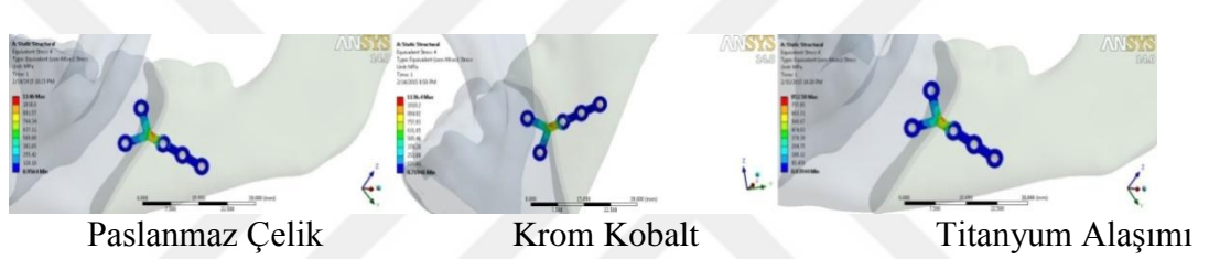
Şekil 3.8. Y plak üzerinde oluşan gerilmeler [129].
