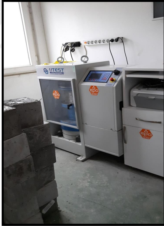
Şekil 3.12. Beton numunelerin zerinde basın deneylerinin yapılması.
