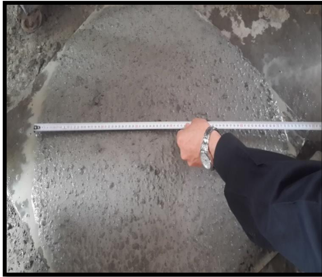
Şekil 3.9. SBK Katkılı Kendinden Yerleşen Beton yayılımı.
