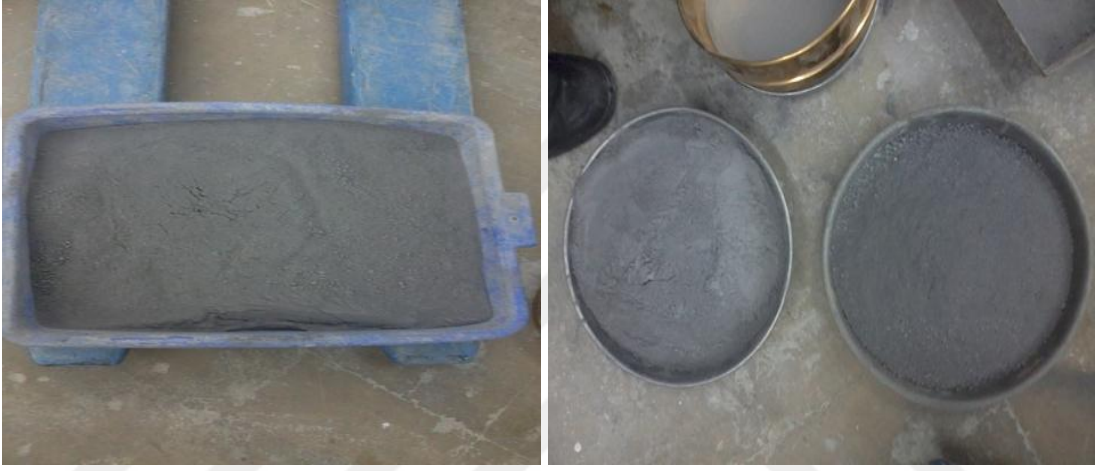
Şekil 2.1. Elazığ ferrokrom cürufunun öğütme ve eleme işlemi.
