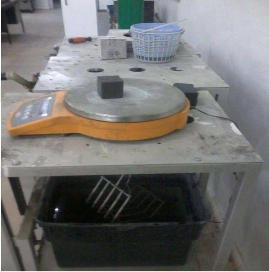
Şekil 2.10. Birim ağırlık (yoğunluk) deneyi
