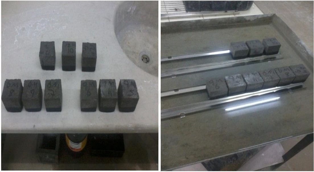
Şekil 2.8. Kapilarite deneyi için numunelerin hazırlanması
