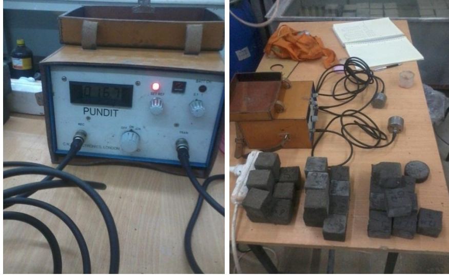
Şekil 2.7. Ultrases test cihazı
