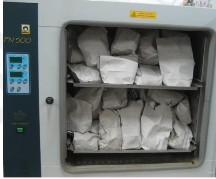
Şekil 3.26. Araziden alınmış organik madde örneklerinin kurutma fırınında kurutulması
