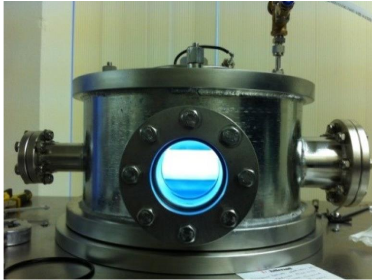
Şekil 2.1. a-C:H ince film üretiminde kullanılan plazma kazanı [16].
