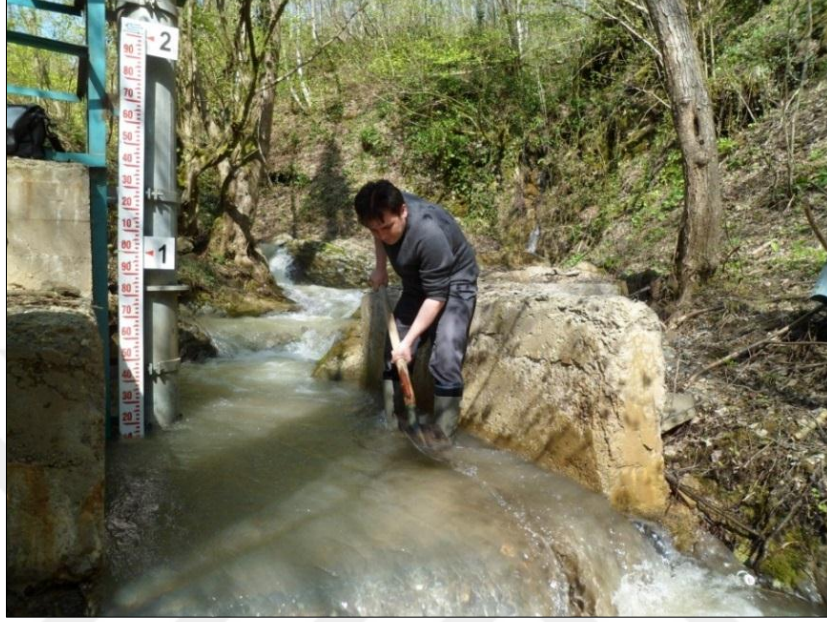
Şekil 2.10. Ölçüm noktalarında biriken sedimentin temizlenmesi.
