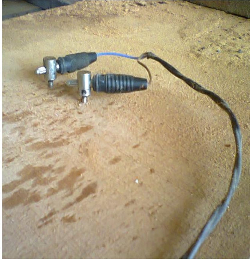
Şekil 2.3. 40 mm ve 50 mm Doğu kayını kerestelerine ait kurutma denemesinde kerestelere rutubet okuma duyucusunun (sensörü) yerleştirilmesi.
