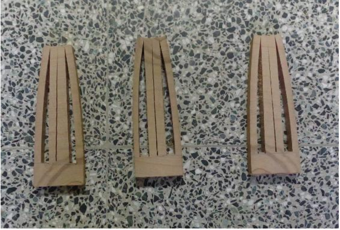
Şekil 3.1. 40 mm kalınlıktaki kerestelerden alınan çatal örnekler.
