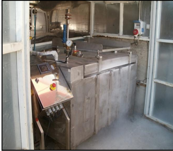
Şekil 4.3. Üstten yüklemeli kriyojenik işlem fırını (Kara, 2014).
