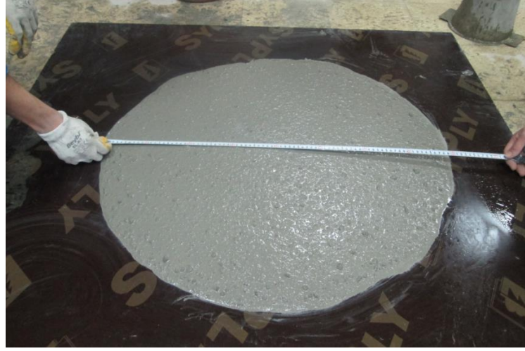
Şekil 5.10. Çökmede yayılma deneyinin uygulanışı.
