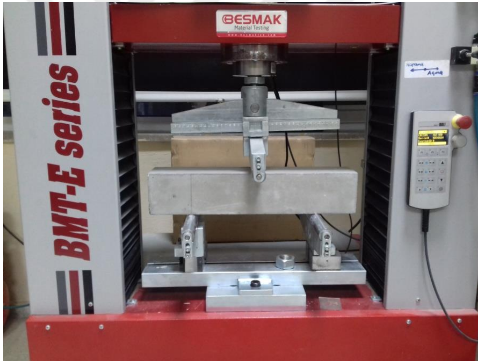
Şekil 5.18. Eğilme dayanımı deneyinin uygulaması
