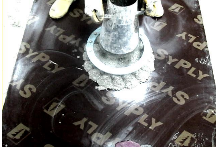
Şekil 5.13. J Halkası deneyinin uygulanışı.
