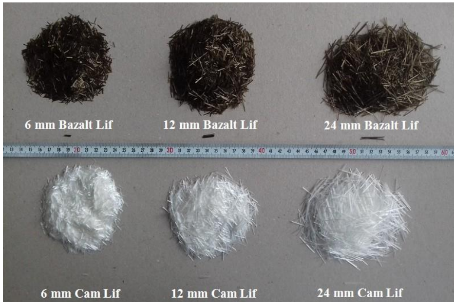
Şekil 5.5. Çalışma kapsamında kullanılan farklı uzunluklardaki cam ve bazalt lifler.
