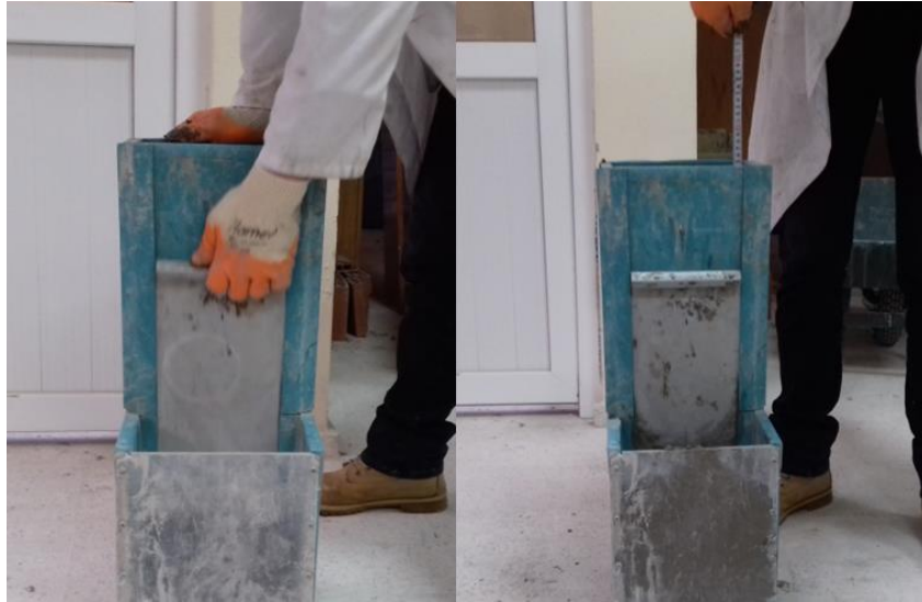
Şekil 5.14. U kutusu deneyinin uygulanışı.
