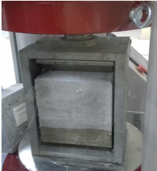
Şekil 5.19. Yarmada çekme deneyinin uygulanışı
