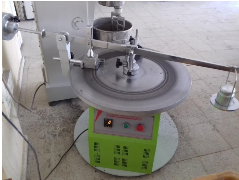
Şekil 5.22. Böhme deney cihazı ile aşınma dayanımı deneyinin uygulanması
