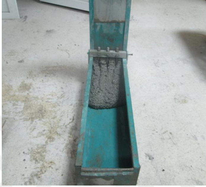
Şekil 5.12. L kutusu deneyinin uygulanışı.
