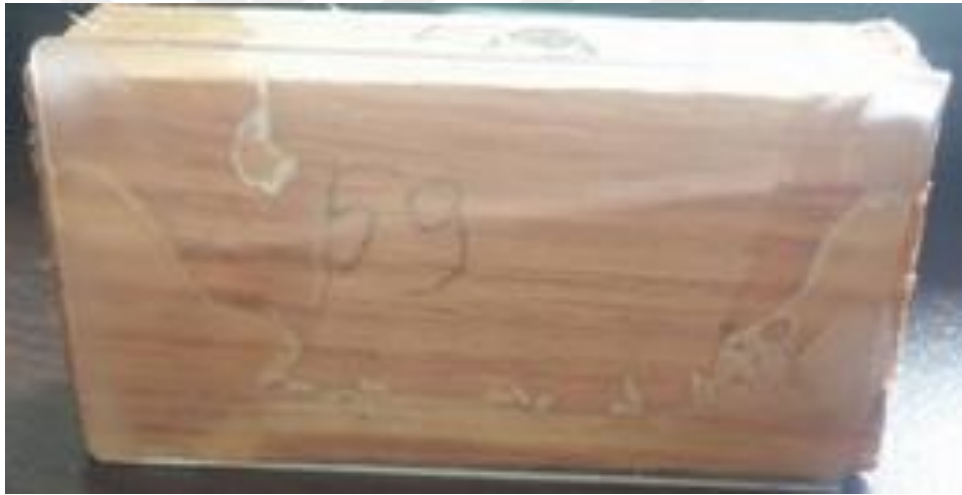
Şekil 3.9. Hylotrupes bajulus larvaları yerleştirilmiş deney örneği.
