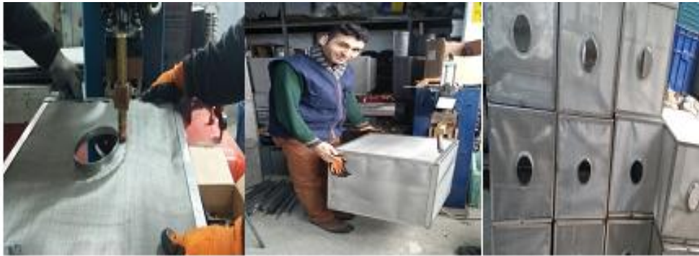
Şekil 3.3. Böcek toplama kafeslerinin üretimi.
