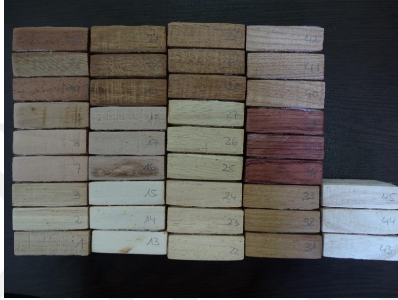
Şekil 3.10. Larva deneylerine uygun olarak hazırlanan bazı yerli ve tropikal odun örnekleri.
