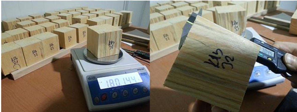
Şekil 2.7. Tahribatsız test örneklerinin ağırlık ve hacim ölçümü.
