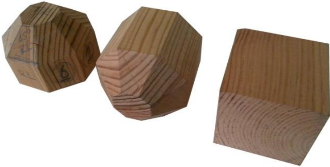
Şekil 2.4. 26 yüzeyli tahribatsız test örneğinin hazırlanma aşamaları.
