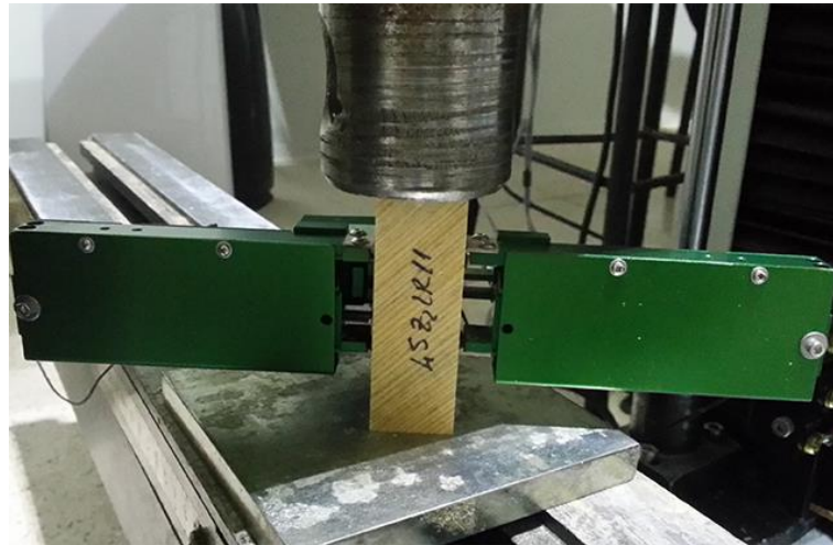
Şekil 2.10. Kızılcam 45^\circ eksen dışı basma testi örneği.
