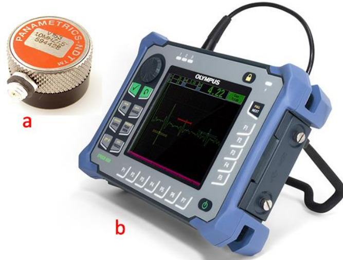
Şekil 2.8. Kesme dalgası transdüseri (a) ve EPOCH 650 Ultrasonik hata dedektörü (b).
