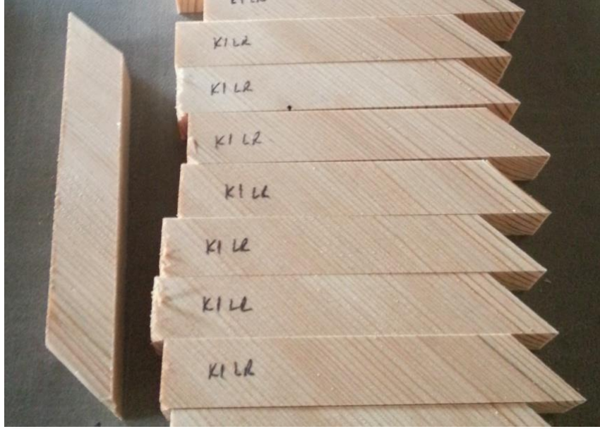
Şekil 2.5. Eksen dışı basma örneğinin hazırlanışı.
