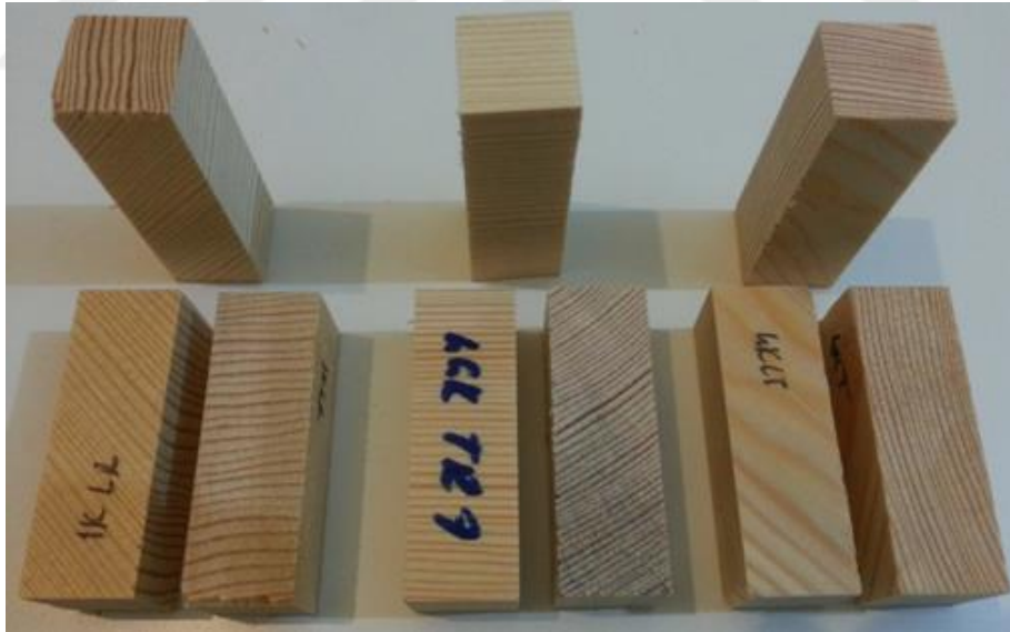
Şekil 2.6. LR, LT ve RT eksen dışı basma örneklerinin üç kesitinin görünüşü.
