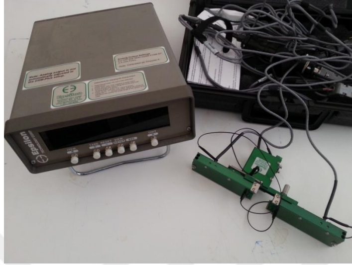
Şekil 2.11. Epsilon marka bi-aksiyal ekstensometre.
