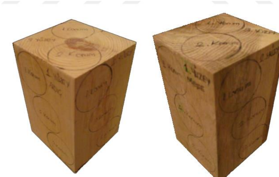
Şekil 1.19. Cansu [123]'ya ait ultrasonik test örnekleri.
