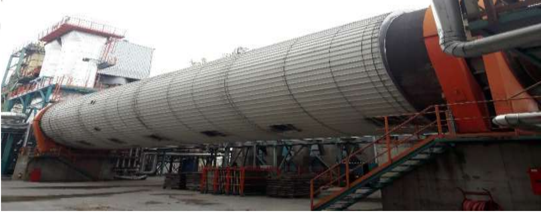
Şekil 1.9. Döner silindirik kurutma makinası genel görünüşü.
