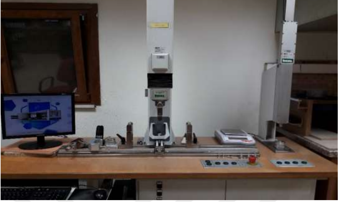
Şekil 2.9. Yongalevhananın eğilme direnci ve eğilmede elastikiyet modülü tayini.
