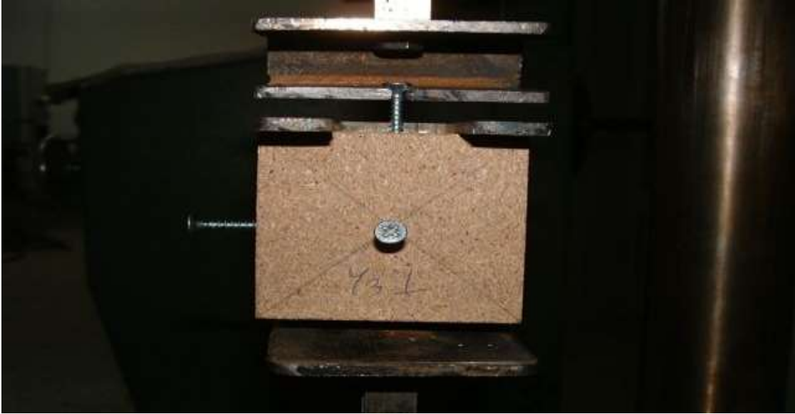
Şekil 2.13. Vida tutma kabiliyeti deneyinin yapılışı (yüzeeye paralel).
