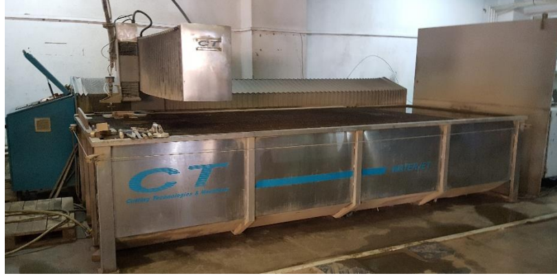
Şekil 4.3. Örneklerin kesilmesinde kullanılan ASJ makinesi.
