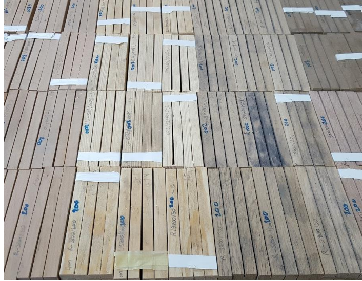
Şekil 4.5. Kenar fazlalıkları kesilmiş örnekler.
