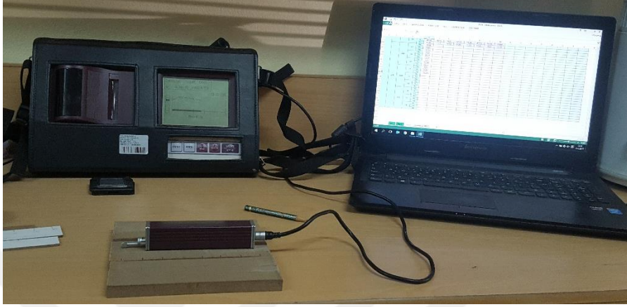
Şekil 4.6. Yüzey pürüzlülük ölçüm cihazı.
