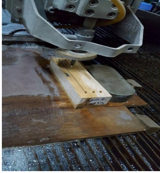
Şekil 4.4. Örneklerin ASJ makinesinde kesilmesi.
