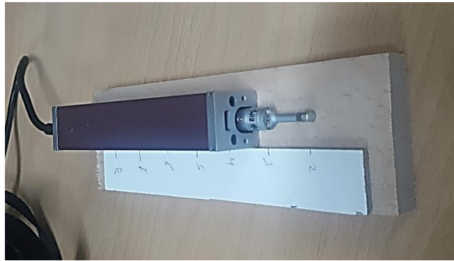
Şekil 4.7. Yüzey pürüzlülük ölçümü.
