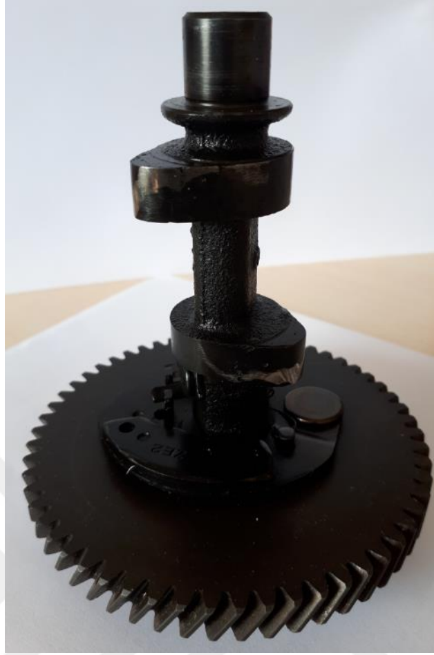
Şekil 4.4. Kam profili yükseltılarak modifiye edilmiş kam mili.
