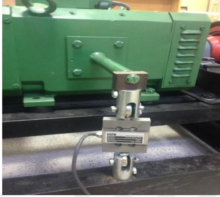
Şekil 5.5. Yük hücresinin görünümü.
