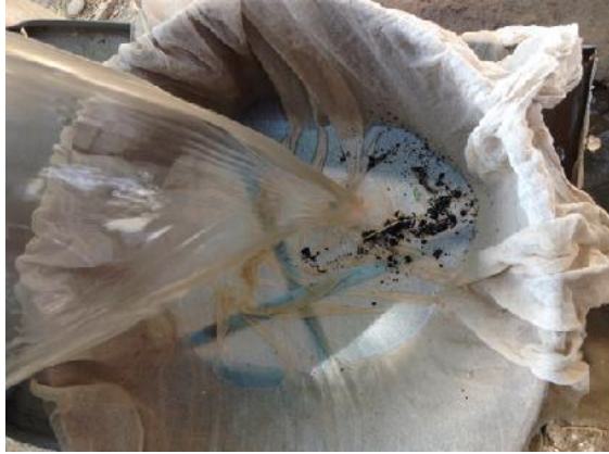
Şekil 3.4. Yüzdürme tankı çalışır durumdayken biriken hafif malzeme.
