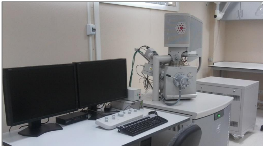
Şekil 7.12. Taramalı elektron mikroskopu.
