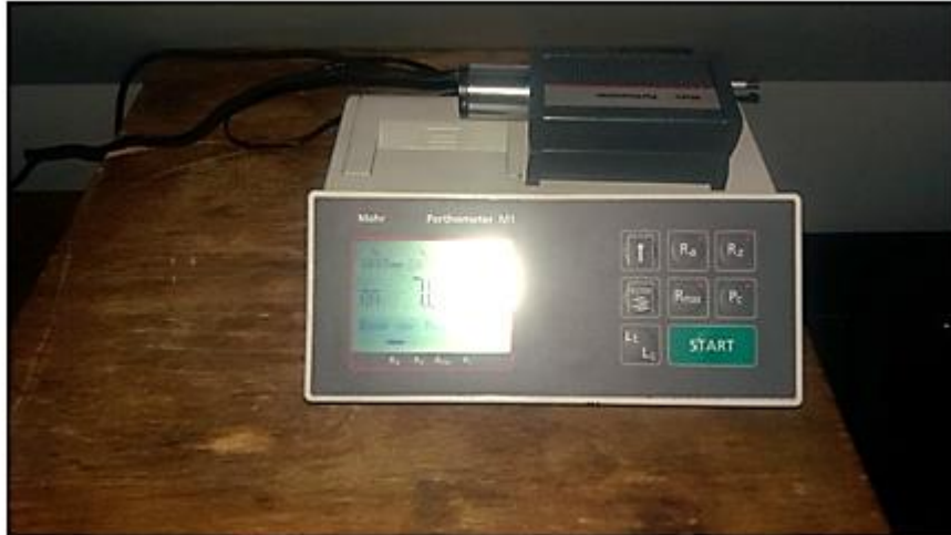
Şekil 7.8. Yüzey Pürüzlülüğü ölçüm cihazı.
