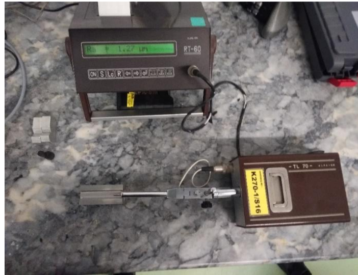
Şekil 3.5. Yüzey pürüzlülük ölçüm cihazı.
